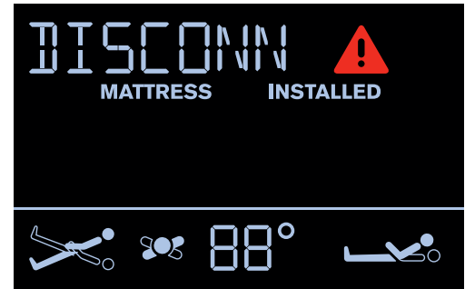
Fig. TUBOS DE AR DESCONECTADOS
