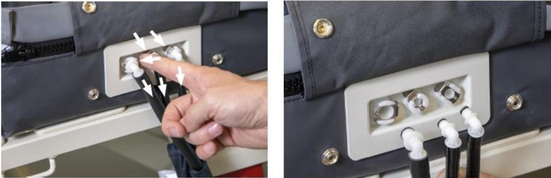
*Fig. 9 Déconnexion des conduits d'air du matelas avec le mode MCM*
