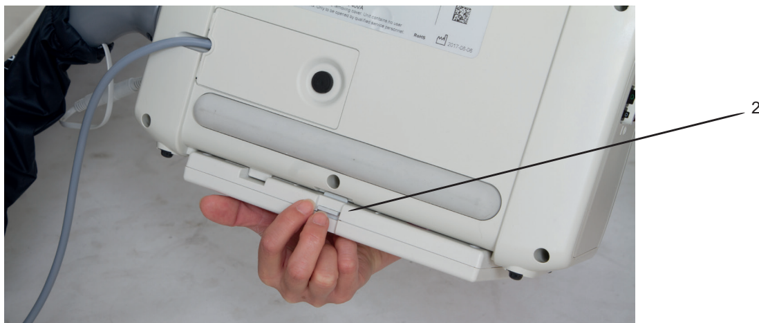
Fig. Remoção do conjunto do acumulador
