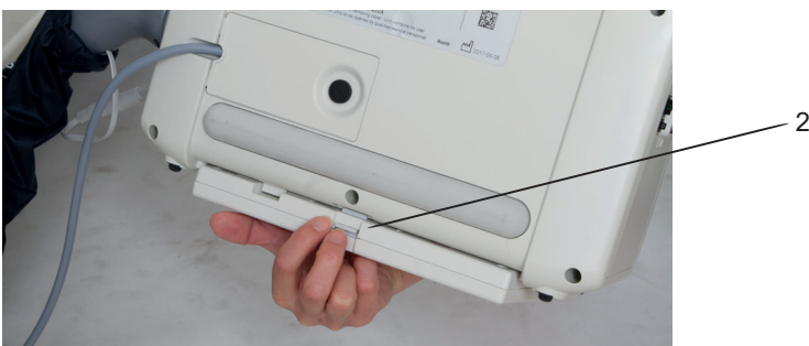
Fig. 22 Retirer la batterie
