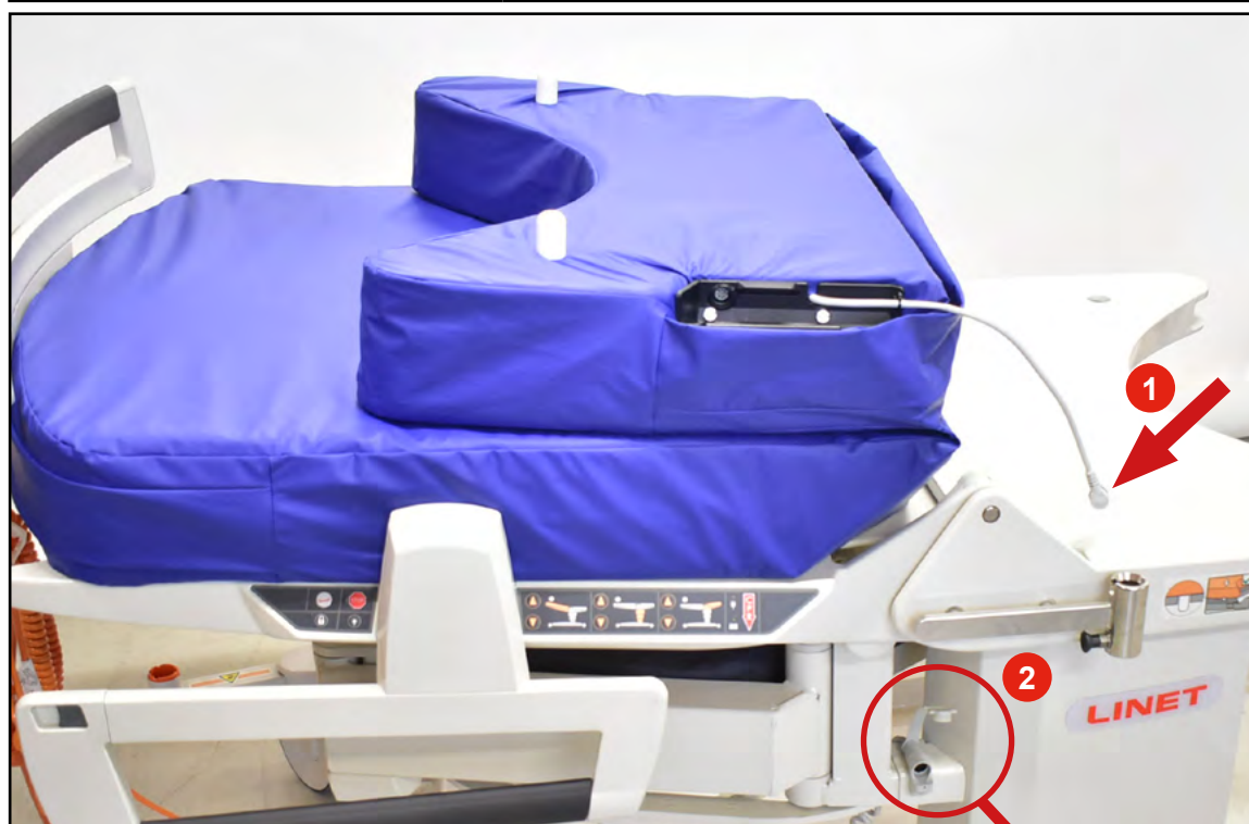
Fig. 30 Déconnexion du câble de connexion et pose d'un capuchon sur le connecteur
