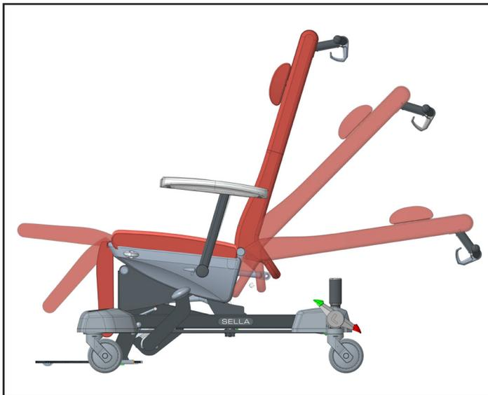
Per cambiare la posizione afferriamo il manubrio con entrambe le mani e contemporaneamente reggiamo la leva di comando. Premendo sulla maniglia o tirandola regoliamo la posizione desiderata del piano di carico. Dopo aver lasciato la leva di comando questa posizione rimane fissa.
