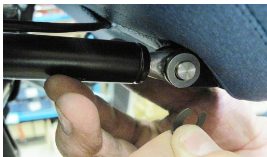
Schema van de verbinding tussen de gasveer en de nok van de rugleuning
