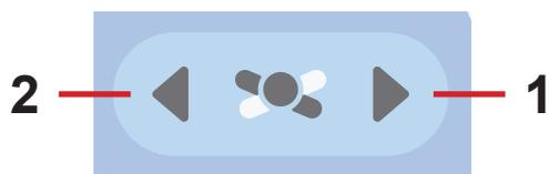
Fig. Boutons d'inclinaison latérale (panneau de commande du soignant)
