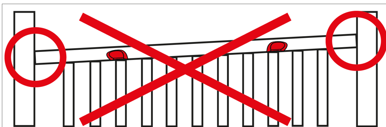
Fig. Sponda laterale non correttamente bloccata
