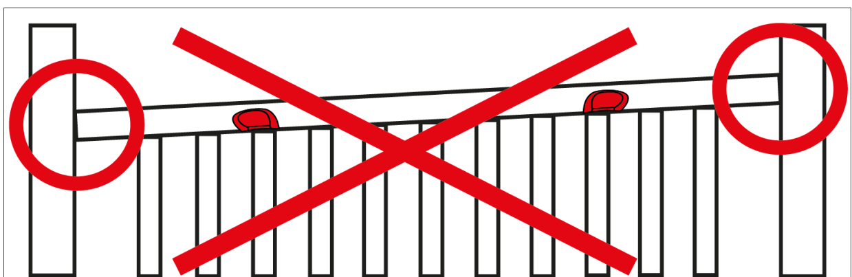
Fig. Barrière mal verrouillée
