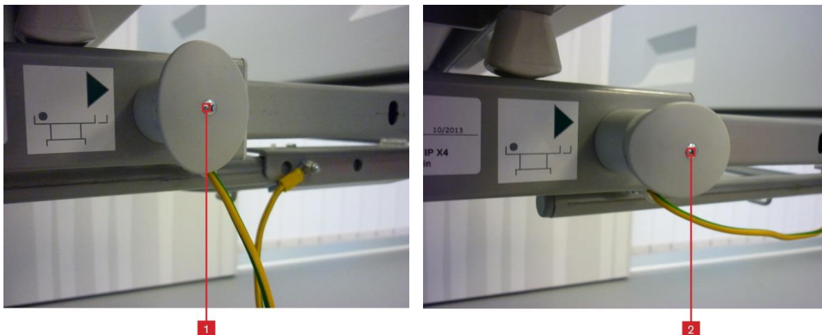
Fig. Bloqueo de seguridad de la extensión de la plataforma del colchón
