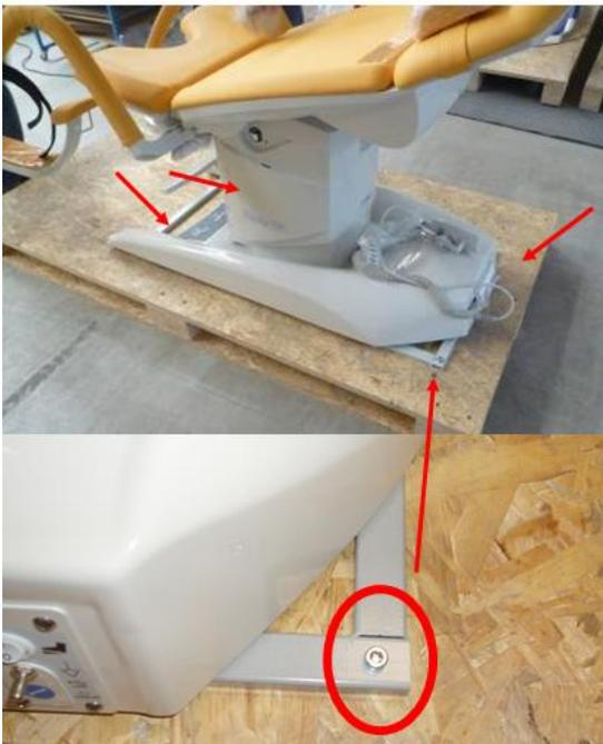
Spingere in avanti la parte posteriore della poltrona sopra la pedana. Avvitare le ruote.
