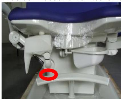
In tal caso si attiva la protezione posta sotto il sedile della poltrona. In caso di collisione impedisce l'ulteriore spostamento del poggiatesta e impedisce danni
