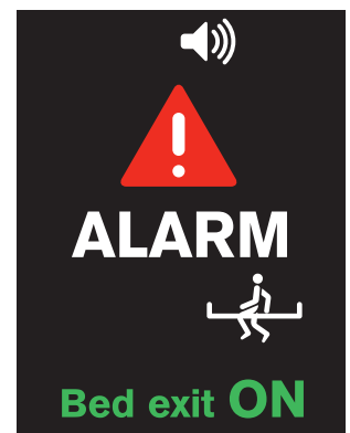
Fig. Signalisation visuelle de l'alarme de sortie du lit (iBoard Basic)
