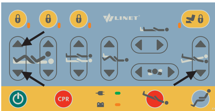
Fig. Disattivazione dell'accumulatore (pannello di controllo operatore)
