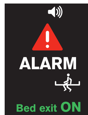
Obr. Vizualní signalizace Bed Exit Alarmu (iBoard Basic)
