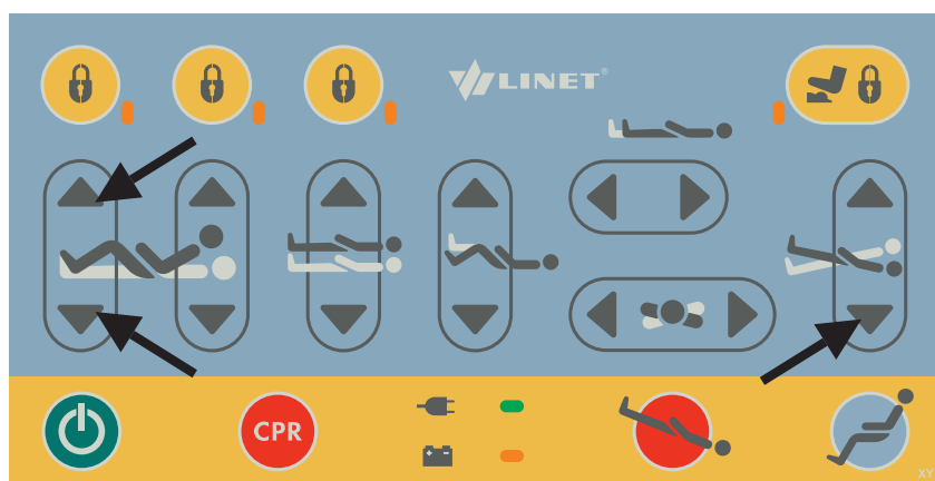
Obr. Deaktivace akumulátoru (Sesterský ovládací panel)
