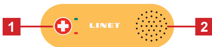
Fig. Elementos de controle da Nurse Call (Chamada de enfermeira) (lado interno da grade lateral da cabeceira)
