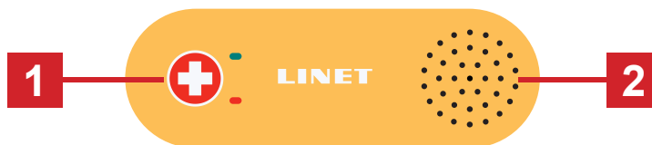
Fig. Éléments de contrôle de la fonction Nurse Call (Appel) (côté intérieur des barrières latérales en tête de lit)
