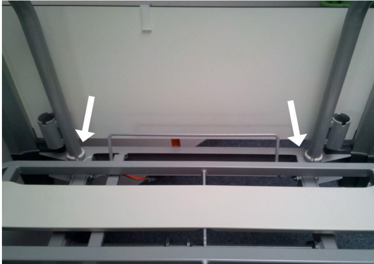
Fig. 14 Placement de pôle de levage
