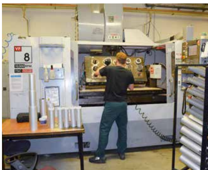
V první fázi části sloupu upraví CNC fréza.
