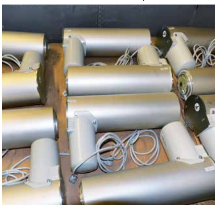
Hotové sloupové jednotky jsou připraveny pro montáž lůžek.
