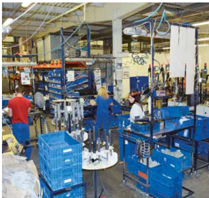
Sloupy se kompletují s dalšími součástmi na montážní lince.
